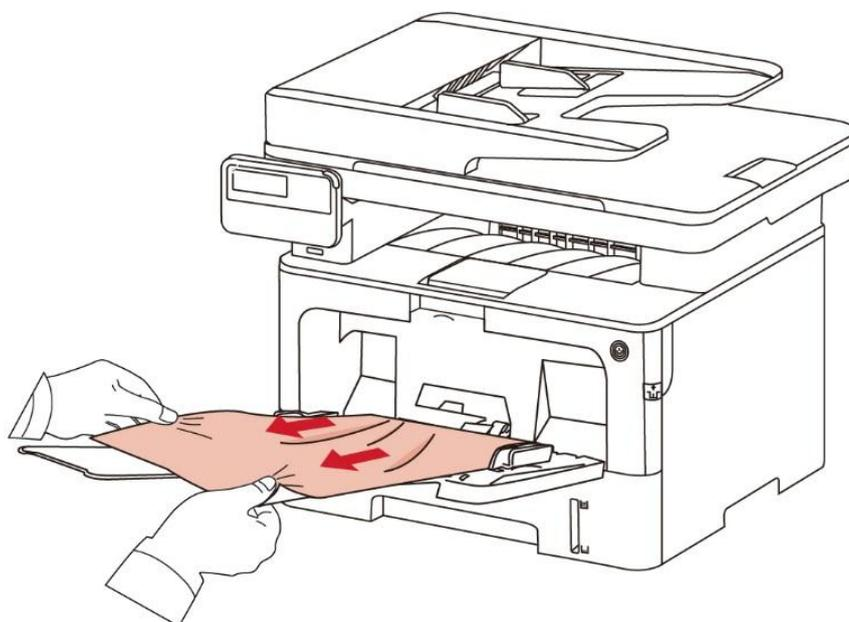
2. 取出后重新装入纸张，按前盖开关按钮，开合前盖，打印机将恢复打印。
