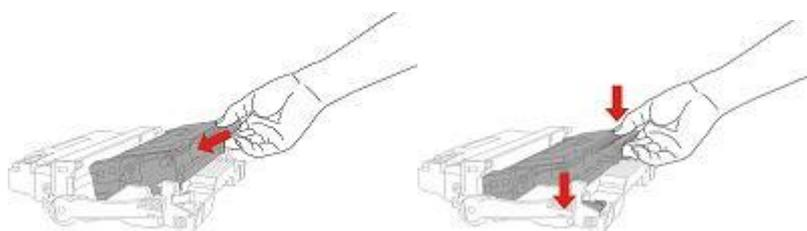
6. 拿起安装完粉盒的鼓组件，沿着打印机内导轨装入已安装了粉盒的鼓组件，完成安装。
