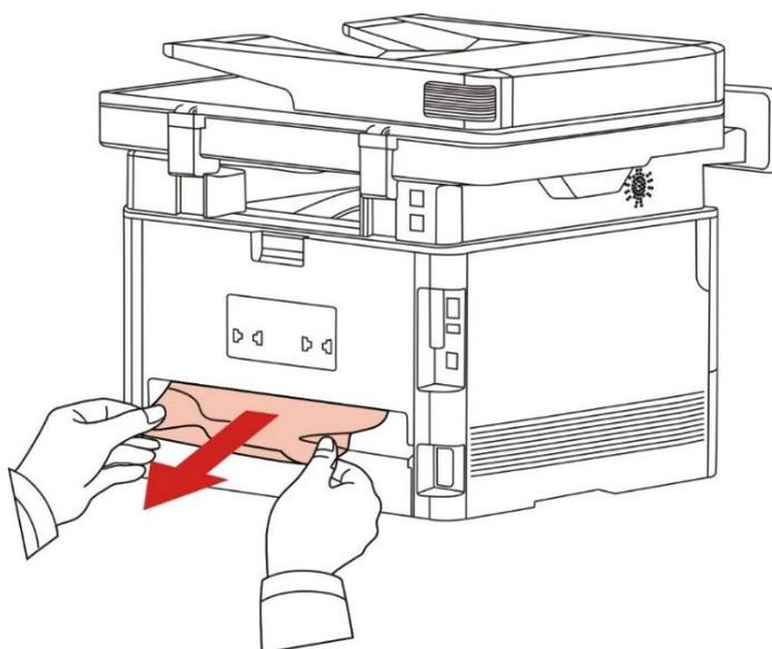
4. 取出卡纸后，装回双面打印单元，检查产品其他部位，确保无卡纸后，开合前盖，打印机将自动恢复打印。
