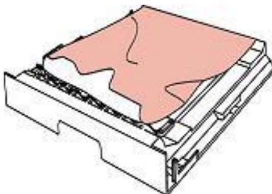
3. 如果纸张未随双面打印单元一起出来，请打开纸盒直接从底部取出卡纸。
