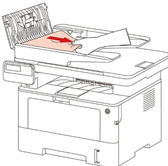
3. 取出卡纸后，合上文档进纸器上盖，打印机恢复就绪。
