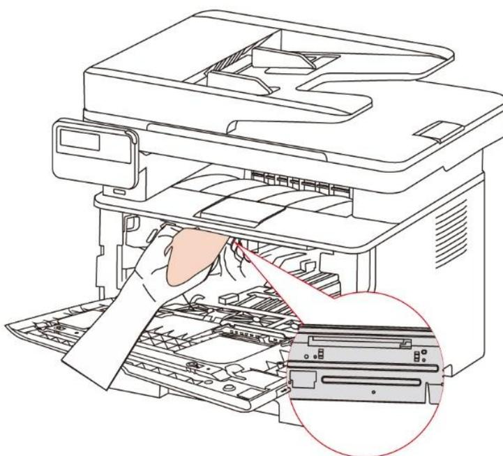
6. 打开打印机的自动进纸盒，用干燥无绒布料轻轻擦拭打印机给纸辊。
