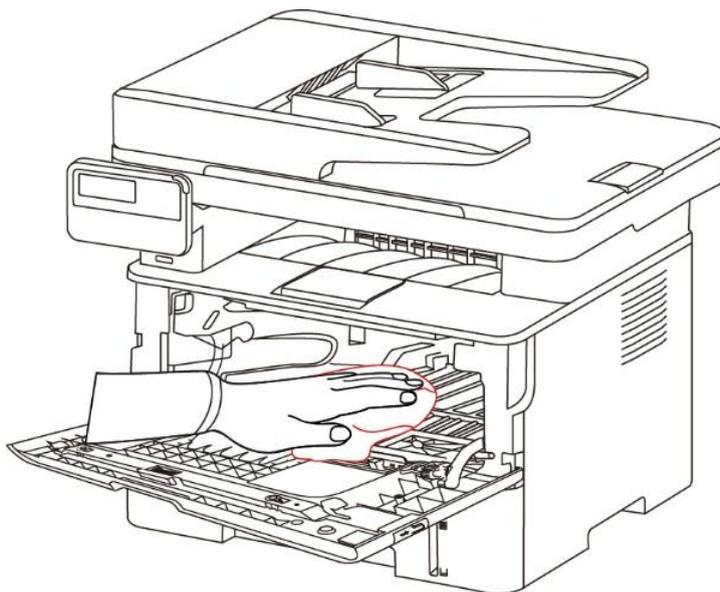
5. 用干燥无绒布料轻轻擦拭打印机 LSU 镜片。
