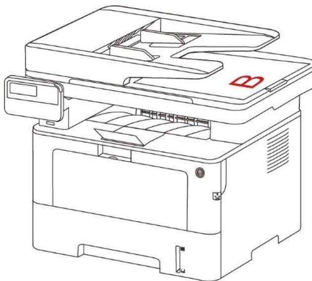
5. 第一面复印结束后，把纸张按图示方向放入进纸口（无需翻转与旋转）。
