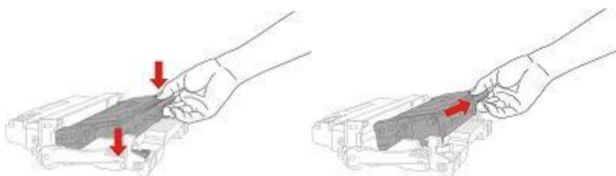
4. 打开新的鼓组件包装，取下鼓组件保护装置，将鼓组件放置于水平台面。
