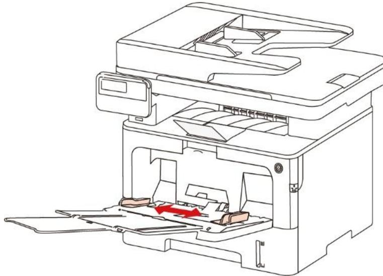
4. 请在装入纸张之前展开堆栈的纸张，避免卡纸或进纸错误，再把纸张打印面朝上装入纸盒内，多功能进纸盒最多可装入 60 张 80g/m<sup>2</sup>纸。
