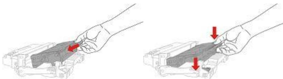
7. 拿起安装完粉盒的鼓组件，沿着打印机内导轨装入已安装了粉盒的鼓组件，完成安装。
