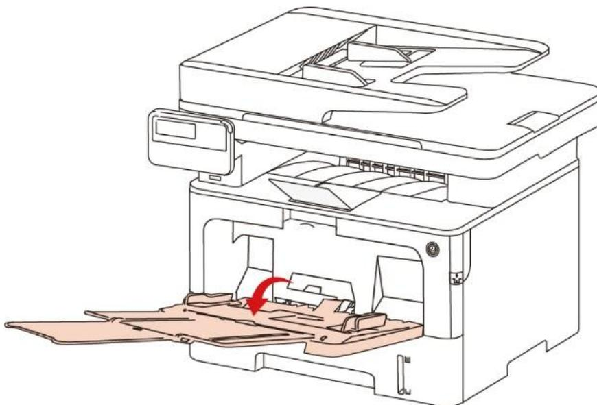
3. 滑动多功能进纸盒的导纸板以匹配纸张的两侧。不要用力过度，否则会导致卡纸或纸张歪斜。
