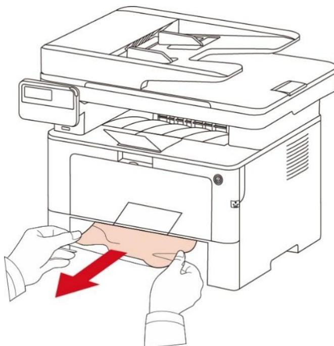
3. 取出卡纸后，请将纸盒重新装入打印机，开合前盖，打印机将自动恢复打印。
