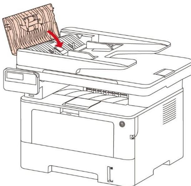
4. 若卡纸张较难取出，可尝试打开扫描仪盖，从压块处取出卡纸。
