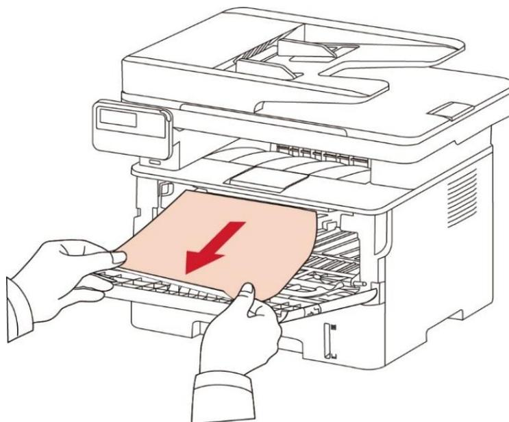
7. 取出卡纸后，重新装入粉盒，合上前盖，打印机将恢复打印。
